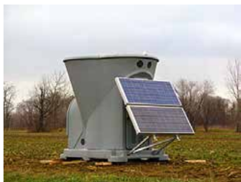
SODAR installé sur site
